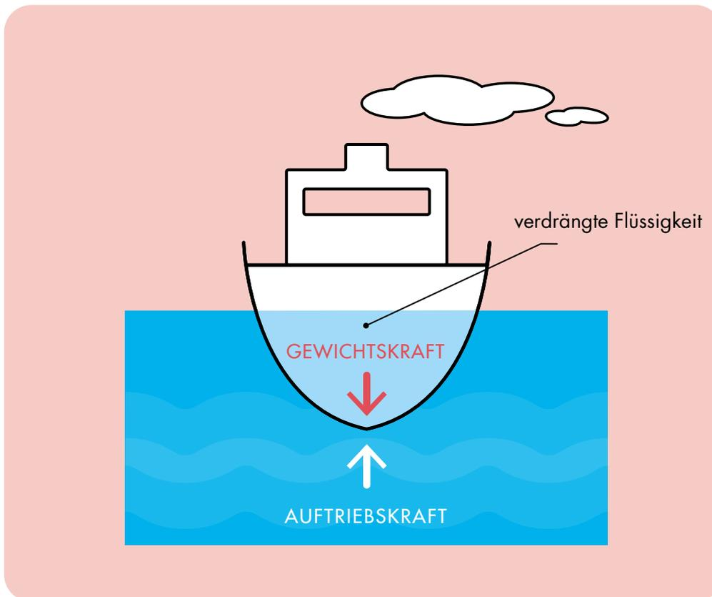
Abb. 11: Die Auftriebskraft hängt vom Volumen der verdrängten Flüssigkeit ab.
